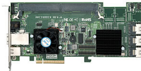
RAIDカード Areca ARC-1680ix-12 2GBキャッシュモデル
